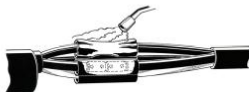
Figur 4: Centrera isoleringsrören över skarvhylsorna. Krymp ned med början från mitten.
