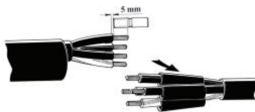
Figur 2: Avisolera enligt bild. Träd på isoleringsrören över de längsta ledarna.
